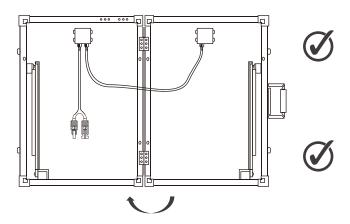
2. Lösen Sie die Flügelmutter, neigen Sie sie in den gewünschten Winkel, und verriegeln Sie die Flügelmutter
