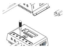
2. Schließen Sie den Adaptersatz an die MC4-Anschlüsse an, die von der Anschlussdose des Satzes kommen.
