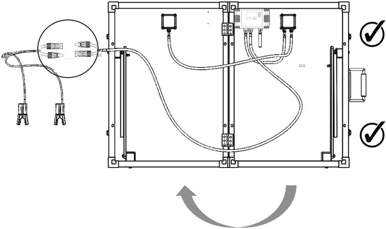
2. Schließen Sie die Batterie-Krokodilklemmen an die 12-Volt-Batterie an
