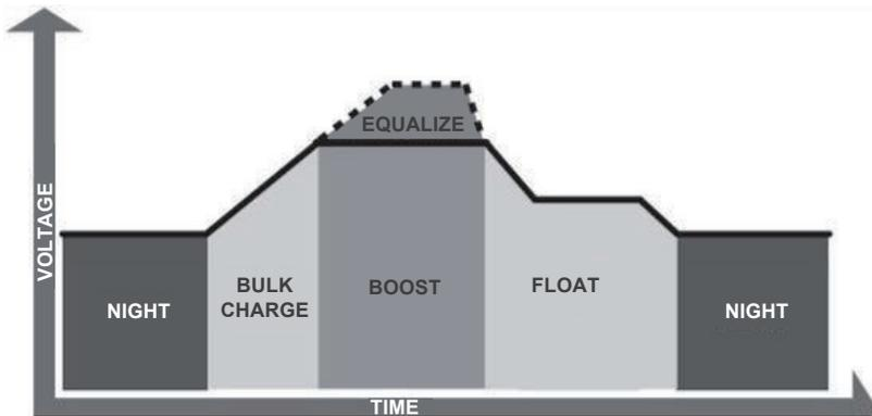
**Schnellladephase:** für tägliches Laden. Der Regler liefert 100% der verfügbaren Sonnenenergie für die zu ladende Batterie und entspricht dem konstanten Strom.
